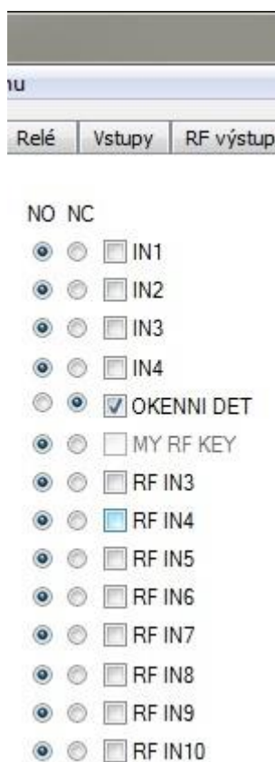
Obr. 31: Záložka "ARM/DISARM" – výběr vstupů hlídané zóny a jejich klidového stavu.
