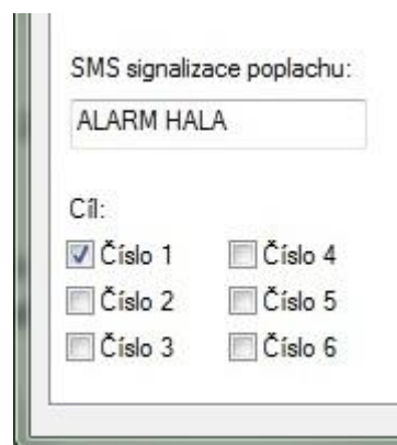
Obr. 33: Záložka "ARM/DISARM" – zadání textu SMS a výběr telefonních čísel.
